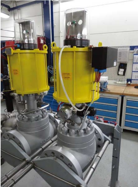
Abb. 6: Schließ- und Öffnungszeittest mit Gasturbinen- Schnellschlussventil [1]
