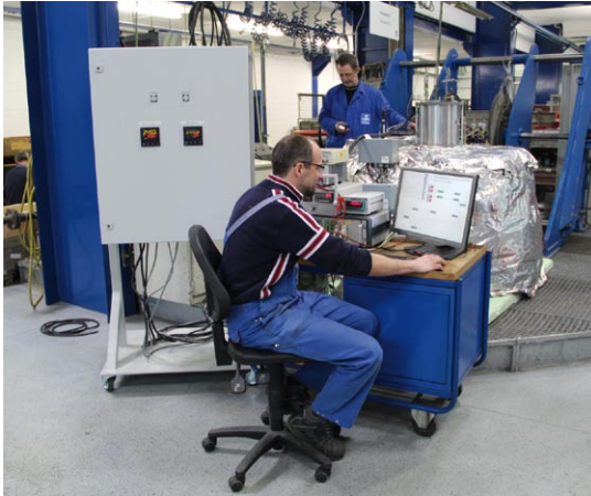
Abb. 5: Gasturbinen-Schnellschlussventil (isoliert, siehe Pfeil) auf dem Temperatur-Prüfstand [1]
